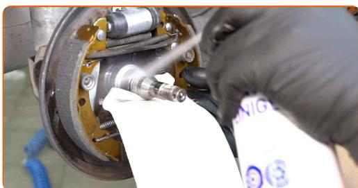
**28** Installez le tambour de frein assemblé avec le roulement du moyeu de roue.
