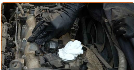
**23** Serrez l'attache de la borne de masse des bobines d'allumage. Utilisez une douille n° 10. Utilisez une clé à cliquet.
