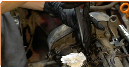
**18** Vissez les nouvelles bougies et serrez-les. Servez-vous de la douille de bougie d'allumage n°16. Utilisez une clé dynamométrique. Serrez-le jusqu'à 25 Nm.
