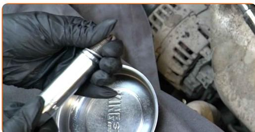
**16** Appliquez une fine couche de graisse spéciale sur la surface filetée des nouvelles bougies d'allumage. Utilisez de la graisse au cuivre.
