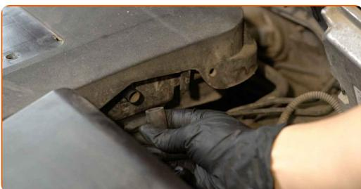
**4** Retirez le cache moteur avec le boîtier du filtre à air.
