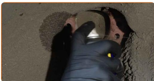
**24** Appliquez du produit sur les emplacements de montage des amortisseurs. Utilisez de la graisse au cuivre.
