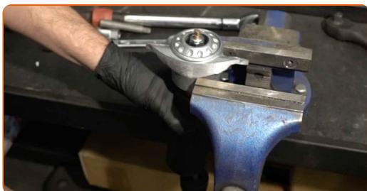
**22** Installez le bouchon de protection sur le support de l'amortisseur.
