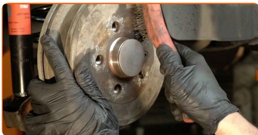
**35** Appliquez du produit sur la surface de contact entre la jante et le tambour de frein. Utilisez de la graisse au cuivre.
