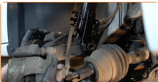
**53** Installez l'écrou de fixation.
