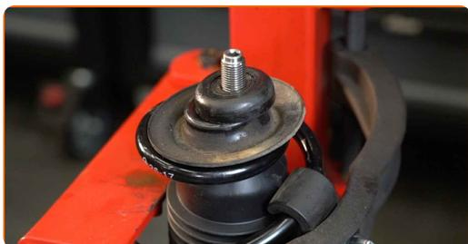
**45** Serrez l'écrou de l'entretoise d'amortisseur due la tige de piston. Utilisez la clé HEX n° H6. Utilisez une douille n° 21. Utilisez une clé dynamométrique. Serrez-le jusqu'à 60 Nm.
