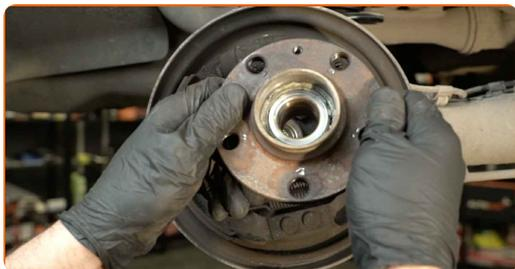
**15** Nettoyez l'emplacement de roulement de moyeu. Servez-vous d'un aérosol nettoyant multi-usages.
