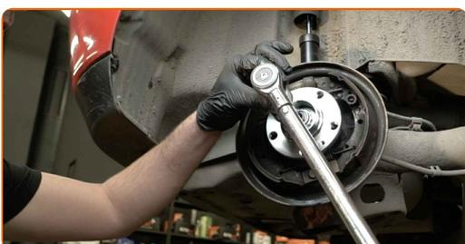
Remplacement : roulement de roue – SEAT Ibiza IV Sportcoupe (6J, 6P). Les professionnels recommandent :
