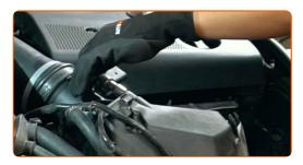
Vissez le collier de fixation reliant le conduit d'air au boîtier de filtre à air. Utilisez une douille n° 7. Utilisez une clé à cliquet.
