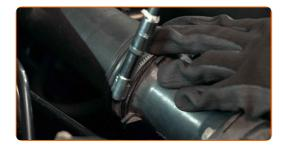
Dévissez les fixations du capteur de débit massique (MAF). Utilisez une douille n° 10. Utilisez une clé à cliquet.
