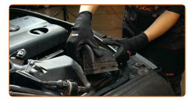
Dévissez les fixations du bouclier thermique du boîtier du filtre à air. Servez-vous d'un tournevis Phillips.
