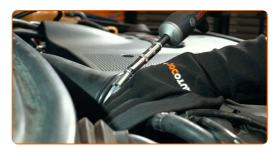
Appliquez du produit sur le débitmètre. Utilisez de la graisse diélectrique.
