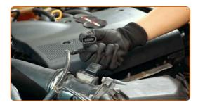
Relâchez le collier de fixation reliant le conduit d'air au boîtier de filtre à air. Utilisez une douille n° 7. Utilisez une clé à cliquet.
