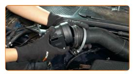
Serrez les fixations du capteur de débit massique (MAF). Utilisez une douille n° 10. Utilisez une clé dynamométrique. Serrez-le jusqu'à 4 Nm.
