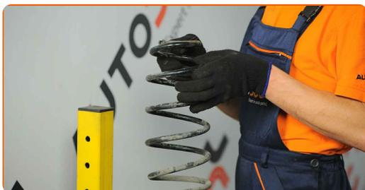
**28** Nettoyez les emplacements de montage des ressorts hélicoïdaux. Utilisez une brosse métallique.
