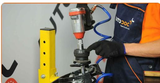
Remplacement : ressort de suspension – SEAT Leon 3/5 portes (1M1).
