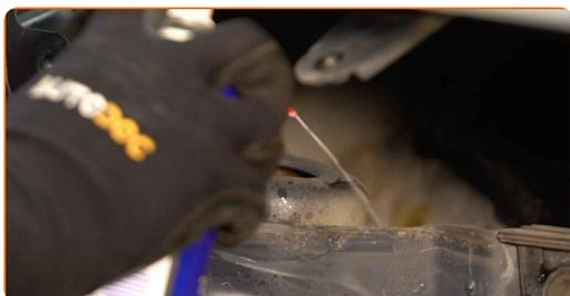
**19** Dévissez les fixations supérieures du support de la jambe de suspension. Utilisez une douille n° 20.6. Utilisez une clé à cliquet.
