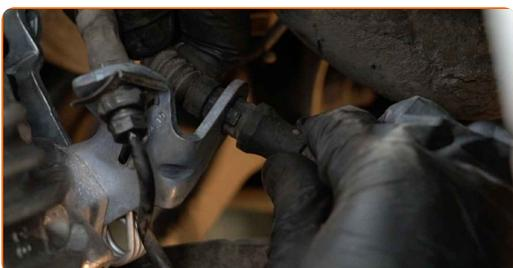
**38** Serrez les fixations de l'étrier de frein. Utilisez une douille n° 13. Utilisez une clé dynamométrique. Serrez-le jusqu'à 35 Nm.
