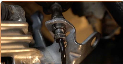
**27** Vissez la fixation reliant la conduite de frein au flexible de frein. Utilisez une clé mixte de No.11
