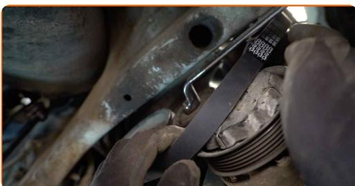
**Remplacement : courroie poly V – SEAT Leon SC (5F5). AUTODOC recommande :**
