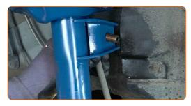
Vissez la fixation qui relie la biellette de barre stabilisatrice à la jambe de suspension. Utilisez une clé mixte de No.18. Servez vous de la douille XZN n°6. Utilisez une clé à cliquet.
