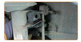
Nettoyez la fixation inférieure reliant la jambe de suspension à la fusée d'essieu. Utilisez une brosse métallique. Servez vous de l'aérosol WD-40.
