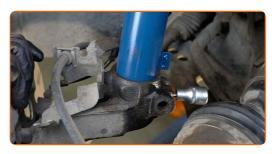
Installez l'écrou de fixation.
