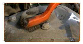
Desserrez les fixations supérieures de la jambe de suspension. Utilisez une douille n° 13. Utilisez une clé à cliquet.
