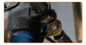
Installez le boulon de l'arbre de transmission et serrez-le. Servez-vous d'une douille 12 pans n°24. Utilisez une clé à cliquet.
