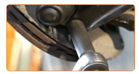
Appliquez du produit sur la fixation qui relie la biellette de barre stabilisatrice à la jambe de suspension. Appliquez du produit sur la fixation reliant la jambe de suspension à la fusée d'essieu. Appliquez du produit sur la fixation du joint à rotule. Utilisez de la graisse au cuivre.
