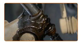
Dévissez les fixations qui lient l'arbre de transmission au moyeu de roue. Servez-vous d'une douille 12 pans n°24. Utilisez un porte-taraud.
