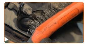
Dévissez les fixations reliant le joint à rotule au bras de commande. Utilisez une douille n° 16. Utilisez une clé à cliquet.
