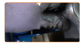
Serrez les fixations reliant le joint à rotule au bras de commande. Utilisez une douille n° 16. Utilisez une clé dynamométrique. Serrez-le jusqu'à 40 Nm.+45°
