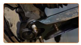
Serrez les fixations qui relient le joint à rotule au bras de suspension. Utilisez une douille n° 16. Utilisez une clé à cliquet.
