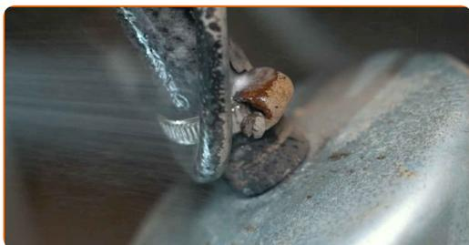
**9** Relâchez les colliers de fixation des tuyaux de filtre à carburant. Utilisez un tournevis plat.
