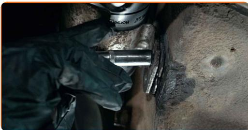
**16** Serrez les colliers de fixation des tuyaux de filtre à carburant. Utilisez un tournevis plat.
