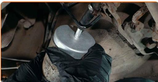
**15** Vissez les boulons de fixation du support du filtre à carburant. Utilisez une douille n° 10. Utilisez une clé à cliquet.
