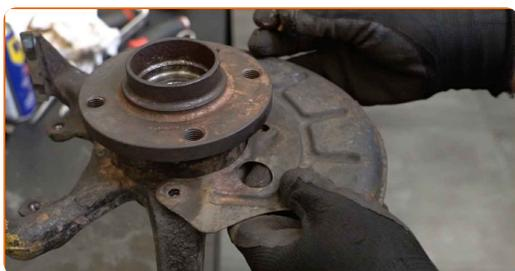
**49** Vissez les fixations sur la protection de disques de frein. Utilisez une clé mixte de No.10.
