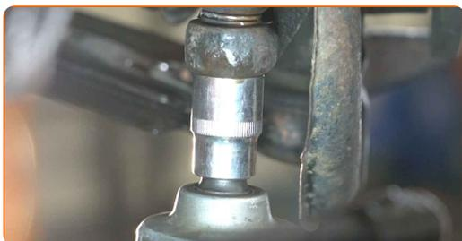
**63** Nettoyez le moyeu. Utilisez une brosse métallique. Traitez la surface de contact. Utilisez de la graisse au cuivre.
