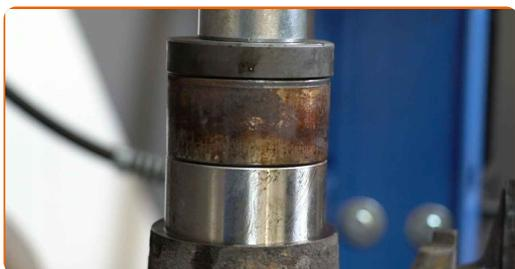
Remplacement : roulement de roue – SEAT TOLEDO I (1L). Les experts d'AUTODOC recommandent :
