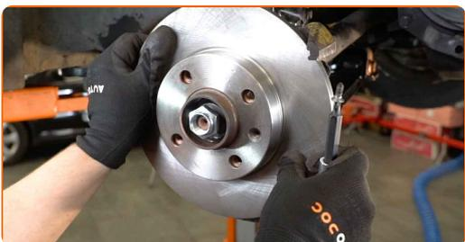
**65** Serrez l'attache du disque de frein. Utilisez la mèche Torx T30. Utilisez une clé dynamométrique. Serrez-le jusqu'à 4 Nm.
