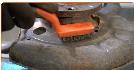
**30** Dévissez les fixations sur la protection de disques de frein. Utilisez une clé mixte de No.10.
