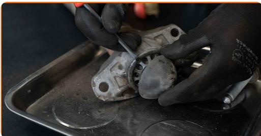
**13** Retirez l'attache de la tige du piston de l'amortisseur. Utilisez une clé mixte de No.16. Servez-vous d'une clé ajustable.
