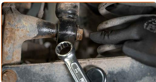
Remplacement : amortisseur – SEAT Toledo III (5P2). AUTODOC recommande
