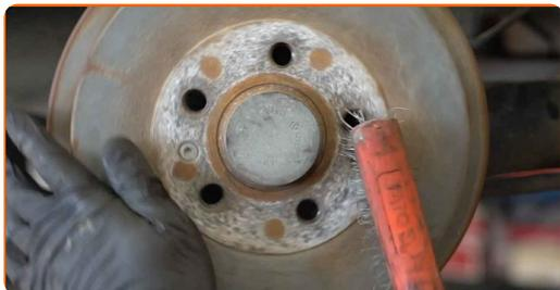
**36** Appliquez du produit sur la surface de contact entre la jante et le tambour de frein. Utilisez de la graisse au cuivre.
