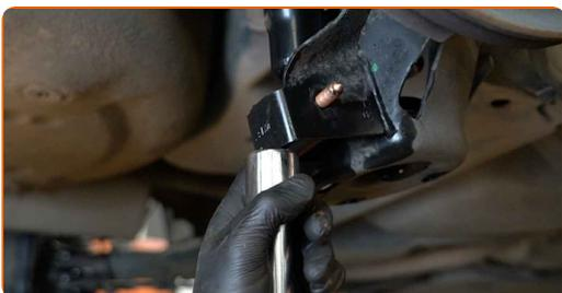
**23** Vissez la fixation inférieure de l'amortisseur. Utilisez une clé mixte de No.16 Utilisez une douille n° 16. Utilisez une clé à cliquet.
