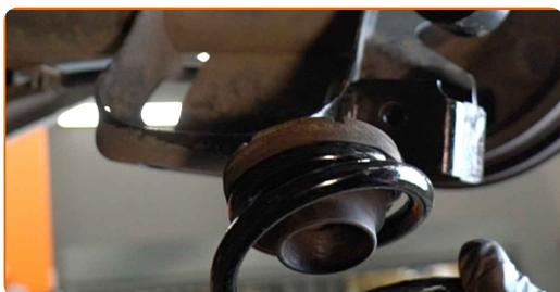
**20** Installez un nouveau ressort hélicoïdal avec ses supports en caoutchouc sur les emplacements de montage.
