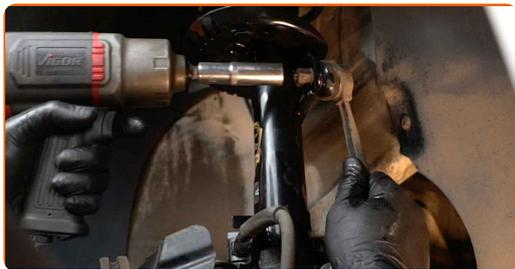
**60** Serrez les fixations inférieures qui relient l'amortisseur à la fusée d'essieu. Utilisez une douille n° 18. Serrez vous de la douille XZN n°14. Utilisez une clé dynamométrique. Serrez-le jusqu'à 60 Nm.+90°
