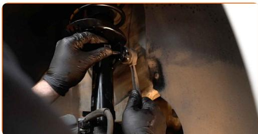
**59** Resserez la fixation de la biellette de la barre stabilisatrice. Utilisez une douille n° 16. Utilisez une clé à cliquet.
