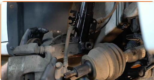
**50** Installez l'écrou de fixation.
