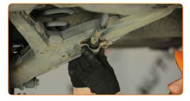
Vissez les fixations des brides de silentblocs de barre stabilisatrice. Utilisez une douille n° 13. Utilisez une clé dynamométrique. Serrez-le jusqu'à 35 Nm.
