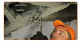
Appliquez du produit sur les brides de silentblocs de barre stabilisatrice. Utilisez de la graisse au cuivre.
