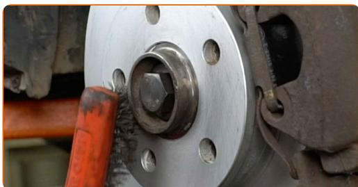
**22** Appliquez du produit sur la zone de contact entre le disque de frein et la jante. Utilisez du lubrifiant céramique.
