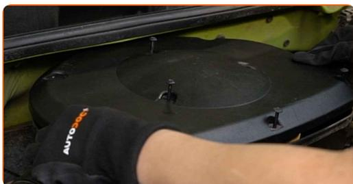
**12** Installez les boulons de fixation.
