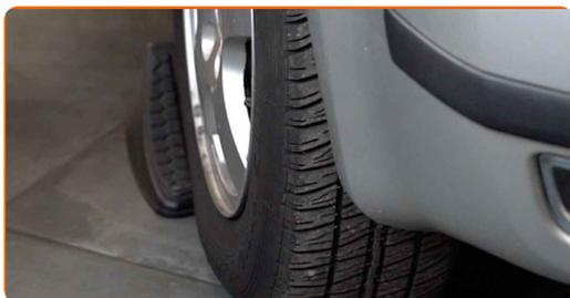
5 Desserrez les boulons de fixation de la roue. Servez-vous d'une douille à choc pour roue N°17.
