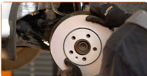
**18** Serrez l'attache du disque de frein. Utilisez une clé dynamométrique. Serrez-le jusqu'à 4 Nm.
