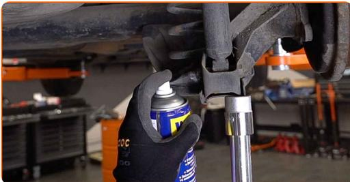
**10** Dévissez l'attache inférieure de l'amortisseur. Utilisez une clé mixte de No.16. Utilisez une douille n° 16. Utilisez une clé à cliquet.
