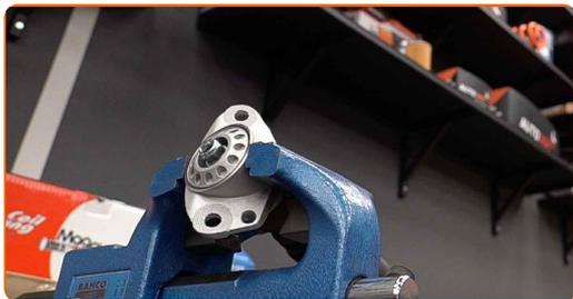
**20** Vissez l'attache supérieure de la tige de piston de l'amortisseur. Utilisez une clé mixte de No.17. Servez-vous d'une clé ajustable. Utilisez une clé dynamométrique. Serrez-le jusqu'à 25 Nm.
