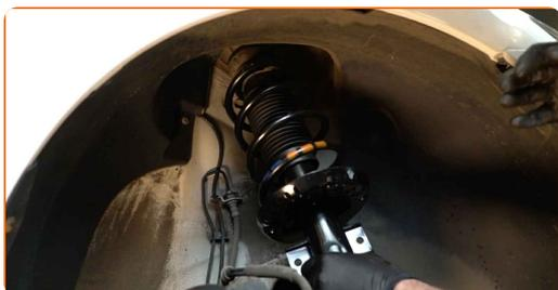
**50** Vissez l'attache supérieure du support de l'amortisseur. Ne serrez pas trop.
