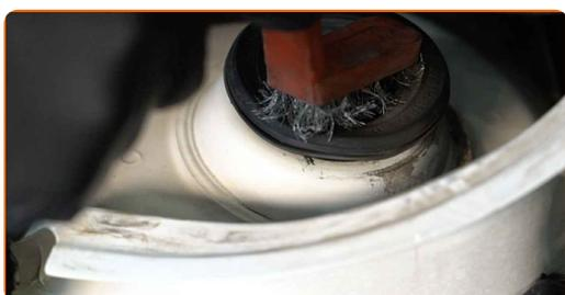
**7** Devissez la fixation supérieure du support d'amortisseur. Utilisez une clé mixte de No.21. Utilisez la clé HEX n° H6. Utilisez une clé à cliquet.
