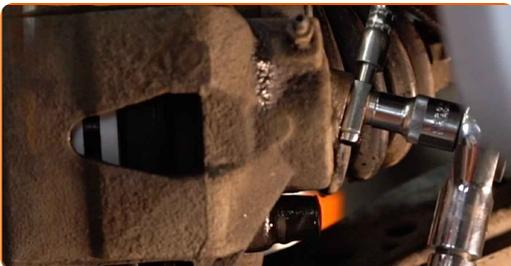
**16** Nettoyez l'emplacement de montage du tuyau de frein sur la conduite de frein. Nettoyez l'emplacement de montage du flexible de frein de l'étrier de frein. Servez-vous d'un nettoyant pour freins.
