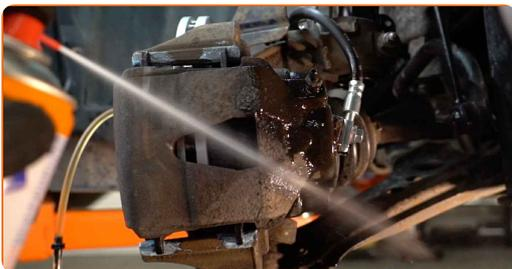
Remplacement : flexible de frein – SKODA Fabia I 5 portes (6Y2). AUTODOC recommande :
