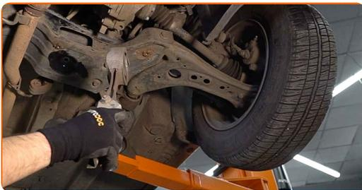
Remplacement : support moteur – SKODA Fabia I 5 portes (6Y2). Les experts d'AUTODOC recommandent :
