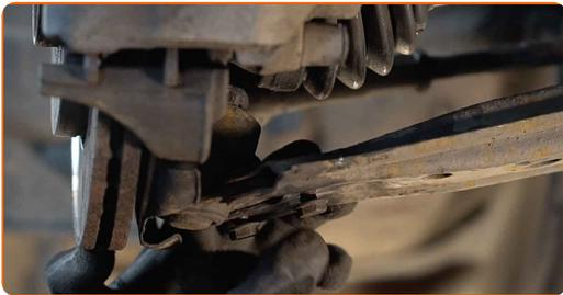
55 Serrez l'attache du joint rotule. Utilisez une douille n° 13. Utilisez une clé dynamométrique. Serrez-le jusqu'à 20 Nm.+90°
