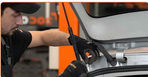
**3** Détendez l'anneau de retenue reliant le vérin à gaz au couvercle de coffre. Utilisez un tournevis plat.
