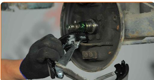
**22** Fixez les mâchoires de frein, ainsi que le dispositif de réglage du frein, au cylindre de roue.
