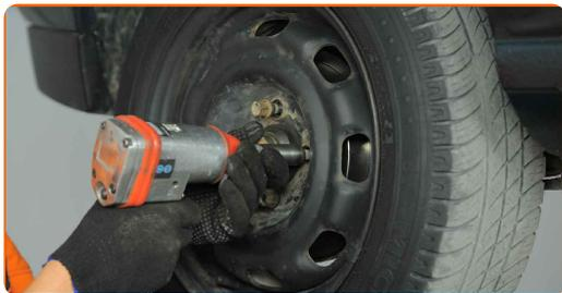
**32** Abaissez la voiture et serrez les boulons de roue en ordre croisé. Servez-vous d'une douille à choc pour roue N°17. Utilisez une clé dynamométrique. Serrez-le jusqu'à 120 Nm.
