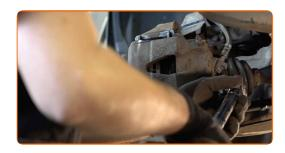
Installez les bouchons anti-poussière des goupilles de guidage de l'étrier de frein.
