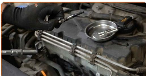
**9** Appliquez du produit sur les bougies de préchauffage. Utilisez du lubrifiant céramique à haute température.
