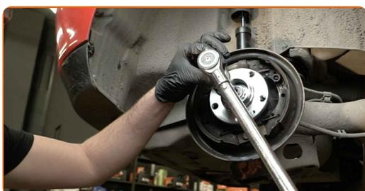
Remplacement : roulement de roue – SKODA Fabia I Praktik (6Y5). Les professionnels recommandent :
