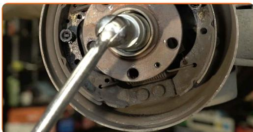
**14** Retirez le moyeu et le roulement puisqu'ils forment un bloc hermétique.
