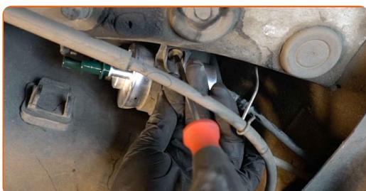
**14** Connectez les lignes d'alimentation en carburant au filtre à carburant.
