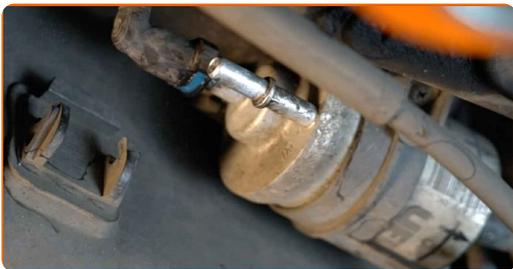
Remplacement : filtre à carburant – SKODA Fabia II Combi (545). Les experts d'AUTODOC recommandent :
