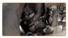
Vissez le bouchon. Utilisez une douille n° 36. Utilisez une clé dynamométrique. Serrez-le jusqu'à 25 Nm.
