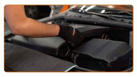
Recouvrez le boîtier-papillon avec un chiffon microfibre pour empêcher que des particules n'entrent dans le système.
