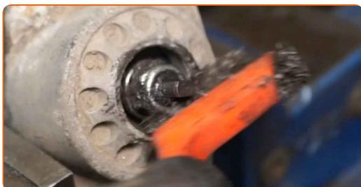
**18** Dévissez la fixation de la tige de piston de l'amortisseur. Utilisez une douille n° 17. Servez-vous d'un embout d'amortisseur n°DD5.2. Utilisez une clé à cliquet.
