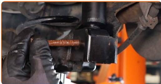
**29** Vissez la fixation inférieure de l'amortisseur. Utilisez une clé mixte de No.16 (2 pièces). Utilisez une clé à cliquet.
