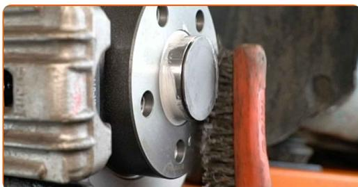
**36** Appliquez du produit sur la zone de contact entre le disque de frein et la jante. Utilisez du lubrifiant céramique.
