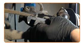
Déserrez l'écrou de bloquage qui retient l'extrémité de la barre stabilisatrice à la barre stabilisatrice. Utilisez une clé mixte de No.22
