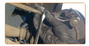
Dévissez l'écrou d'attache d'extrémité à la fusée d'essieu. Utilisez une douille n° 19. Utilisez un porte-taraud.
