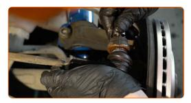
Serrez l'écrou de bloquage de l'extrémité de la barre. Utilisez une clé mixte de No.19 Utilisez une clé mixte de No.22 Utilisez une clé dynamométrique. Serrez-le jusqu'à 50 Nm.
