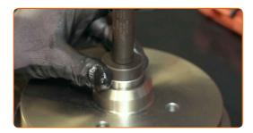
Appliquez du produit sur la bague intérieure et sur le roulement de roue. Servez-vous d'une graisse multi-usages.
