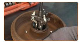
Retirez la bague intérieure du roulement de roue du tambour de frein. Servez-vous d'un coffret de douilles et de roulements.
