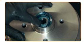
Appliquez du produit à l'endroit où le moyeu de roue entre en contact avec le tambour de frein. Servez-vous d'une graisse multi-usages.
