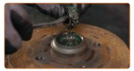
Retirez le joint à huile intérieur du roulement de la roue. Servez-vous d'un pied-de-biche.
