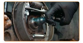
Installez le tambour de frein assemblé avec le roulement du moyeu de roue.
