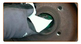
Retirez la bague intérieure du roulement de roue du tambour de frein. Servez-vous d'un extracteur d'engrenage à 3 bras. Servez-vous d'un coffret de douilles et de roulements.
