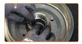
Installez la nouvelle bague intérieure du roulement de roue dans le tambour de frein. Servez-vous d'un coffret de douilles et de roulements. Servez-vous d'un marteau.
