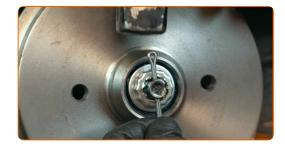
Installez le bouchon de l'écrou du moyeu. Servez-vous d'un marteau.
