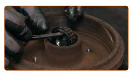
Nettoyez l'emplacement de roulement de moyeu.
