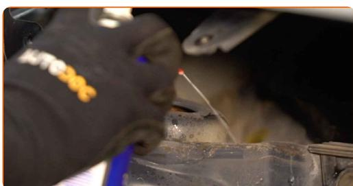
**19** Dévissez la fixation supérieure du support d'amortisseur. Utilisez une douille n° 20.6. Utilisez une clé à cliquet.
