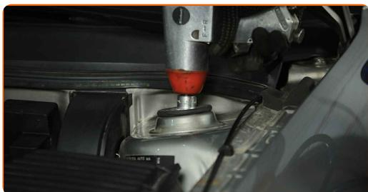
**33** Appliquez du produit sur la fixation supérieure du support de la jambe de suspension. Utilisez de la graisse au cuivre.
