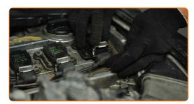
Serrez les fixations des bobines d'allumage. Utilisez la clé HEX n° H5. Utilisez une clé dynamométrique. Serrez-le jusqu'à 12 Nm.
