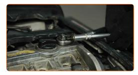
Appliquez une fine couche d'antigrippant à haute température sur les fils des nouvelles bougies d'allumage.
