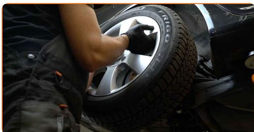
**61** Vissez les boulons de la roue. Servez-vous d'une douille à choc pour roue N°17.
