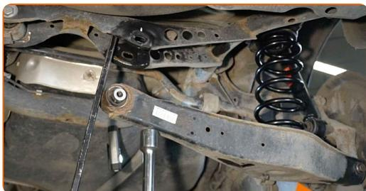
**46** Installez l'écrou de fixation.
