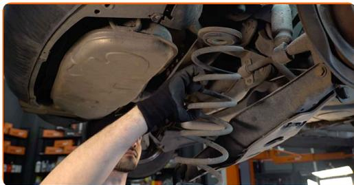
**13** Installez un nouveau ressort hélicoïdal avec ses supports en caoutchouc sur les emplacements de montage. Servez-vous d'un pied-de-biche.
