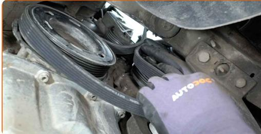
**8** Mettez de côté la poulie de tendeur de la courroie en V crantée. Utilisez une clé mixte de No.16.
