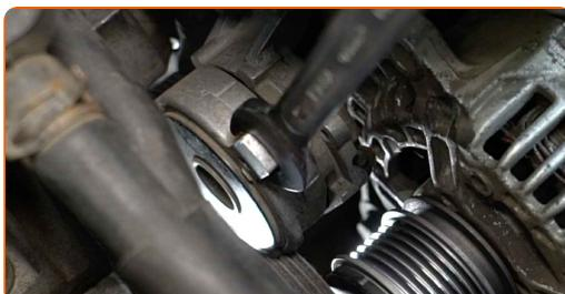
**9** Installez la courroie striée en V sur le tendeur.
