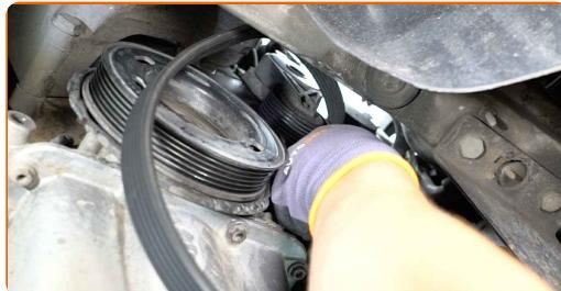
Remplacement : courroie poly V – SKODA Octavia I 5 portes (1U2). AUTODOC recommande :
