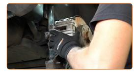
Serrez le support de l'étrier de frein. Utilisez la clé HEX n° H8. Utilisez une clé dynamométrique. Serrez-le jusqu'à 45 Nm.
