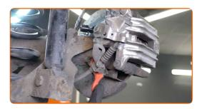
Dévissez les fixations du support d'étrier de frein. Utilisez la clé HEX n° H8. Utilisez une clé à cliquet. Utilisez un porte-taraud.
