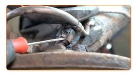
Dévissez la fixation du capteur ABS. Utilisez la clé HEX n° H5. Utilisez une clé à cliquet.
