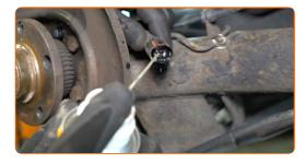
Attachez le connecteur du capteur ABS.
