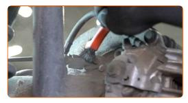
Détachez le connecteur du capteur ABS. Utilisez un tournevis plat.
