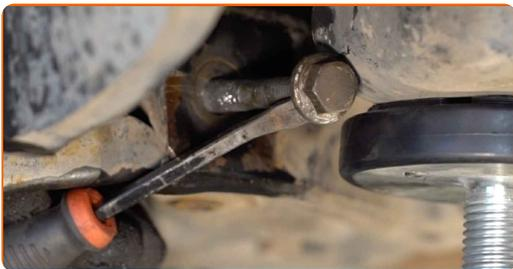
**14** Dévissez la fixation arrière reliant le bras de suspension au cadre auxiliaire. Utilisez une clé mixte de No.18. Utilisez une douille n° 18. Utilisez une clé à cliquet.
