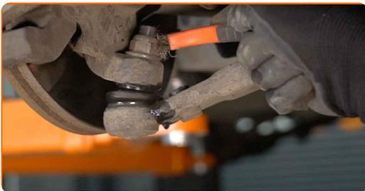
**10** Dévissez l'attache entre le joint rotule et la fusée d'essieu. Utilisez une clé mixte de No.19
