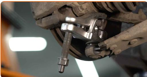
**12** Dévissez l'attache du bras avant. Utilisez une douille n° 18. Utilisez un porte-taraud. Utilisez une clé à cliquet.
