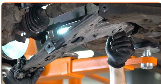
Remplacement : bras inférieur avant – SKODA Octavia I Van / Break (1U5). Les professionnels recommandent :
