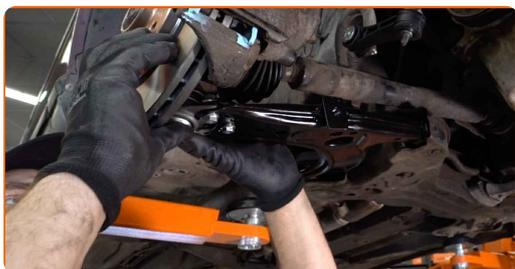
Remplacement : bras inférieur avant – SKODA Octavia I Van / Break (1U5). Les experts d'AUTODOC recommandent :
