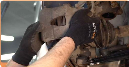
Remplacement : disques de frein – SKODA Rapid 3/5 portes (NH3). Les experts d'AUTODOC recommandent :
