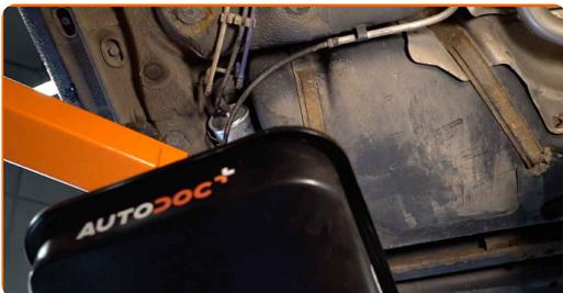
**6** Appuyez sur les clips et détachez les conduites d'admission de carburant du boîtier du filtre à huile. Utilisez un tournevis plat.
