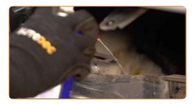
Devissez la fixation supérieure du support d'amortisseur. Utilisez une douille n° 20.6. Utilisez une clé à cliquet.
