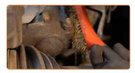
Dévissez la fixation inférieure assurant la connexion entre la jambe d'amortisseur et le porte-fusée. Utilisez une clé mixte de No.18 Utilisez une douille n° 18. Utilisez une clé à cliquet.
