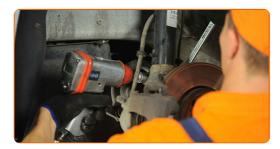
Retirez l'écrou de fixation.
