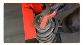
Retirez l'écrou de la tige de piston de l'entretoise. Utilisez une douille n° 20.6. Utilisez une clé à cliquet.
