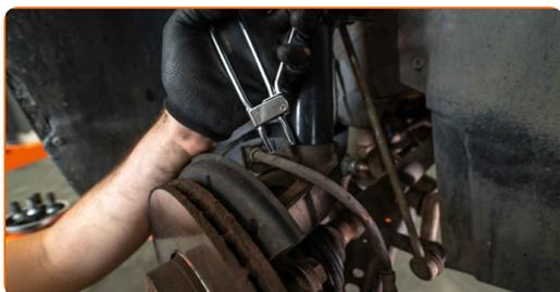
**30** Connectez le capteur électrique d'ABS. Connectez le connecteur du capteur d'usure de la plaquette de frein.
