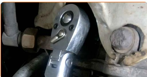
**10** Appliquez du produit sur la sonde lambda. Utilisez du lubrifiant céramique à haute température.
