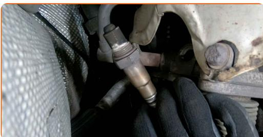
**9** Faire un taraudage pour la nouvelle sonde lambda. Utilisez un taraud. Utilisez une clé à cliquet.
