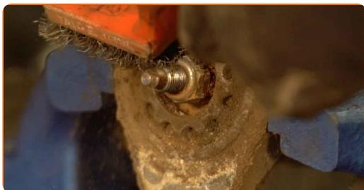
**14** Retirez l'attache de la tige du piston de l'amortisseur. Utilisez une douille n° 17. Utilisez une clé à cliquet.
