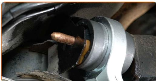
**20** Vissez la fixation reliant la bras de suspension au cadre auxiliaire. Utilisez une clé mixte de No.18
