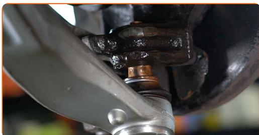
**22** Vissez la fixation reliant le joint à rotule au porte-fusée. Utilisez une clé mixte de No.18
