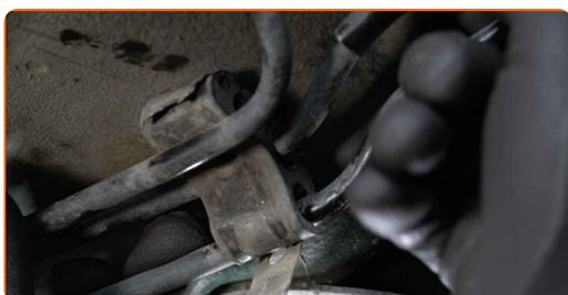
**13** Retirez l'écrou de fixation.
