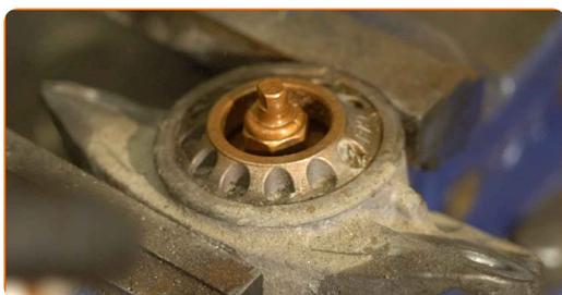
**31** Installez le bouchon de protection sur le support de l'amortisseur.
