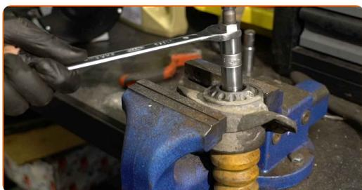
**30** Appliquez du produit sur l'élément de fixation de la tige de l'amortisseur. Utilisez de la graisse au cuivre.
