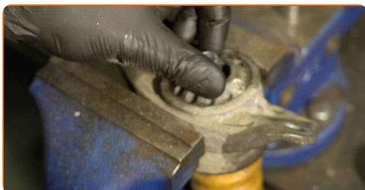
**29** Serrez l'écrou de la tige de l'amortisseur. Servez-vous d'un embout d'amortisseur DDN<sup>o</sup>8. Utilisez une douille n<sup>o</sup> 16. Utilisez une clé dynamométrique. Serrez-le jusqu'à 25 Nm.
