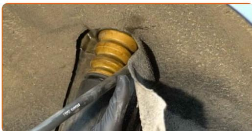
**37** Serrez l'attache de l'amortisseur supérieur. Utilisez une douille n° 16. Utilisez une clé dynamométrique. Serrez-le jusqu'à 50 Nm.+45°
