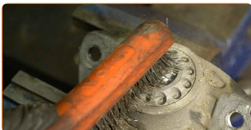
**26** Retirez l'attache de la tige du piston de l'amortisseur. Servez-vous d'un embout d'amortisseur DDN°6. Utilisez une douille n° 17. Utilisez une clé à cliquet.
